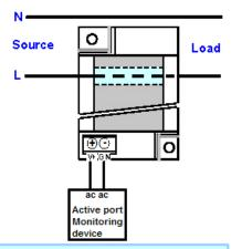
Wiring terminal: 5A/300Vac, M2.0, 0.5~1.3mm<sup>2</sup>(22~16AWG)
